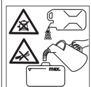
Netankujte se spuštěným motorem. Při tankování nekuřte. Netankujte přímo z kanystru, použijte trychtýř nebo vhodnou nádobu.
