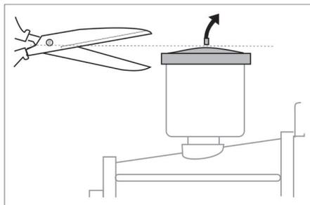
→ Před prvním použitím odšpičte špičku víka nádrže na olej na vodním čerpadle.
